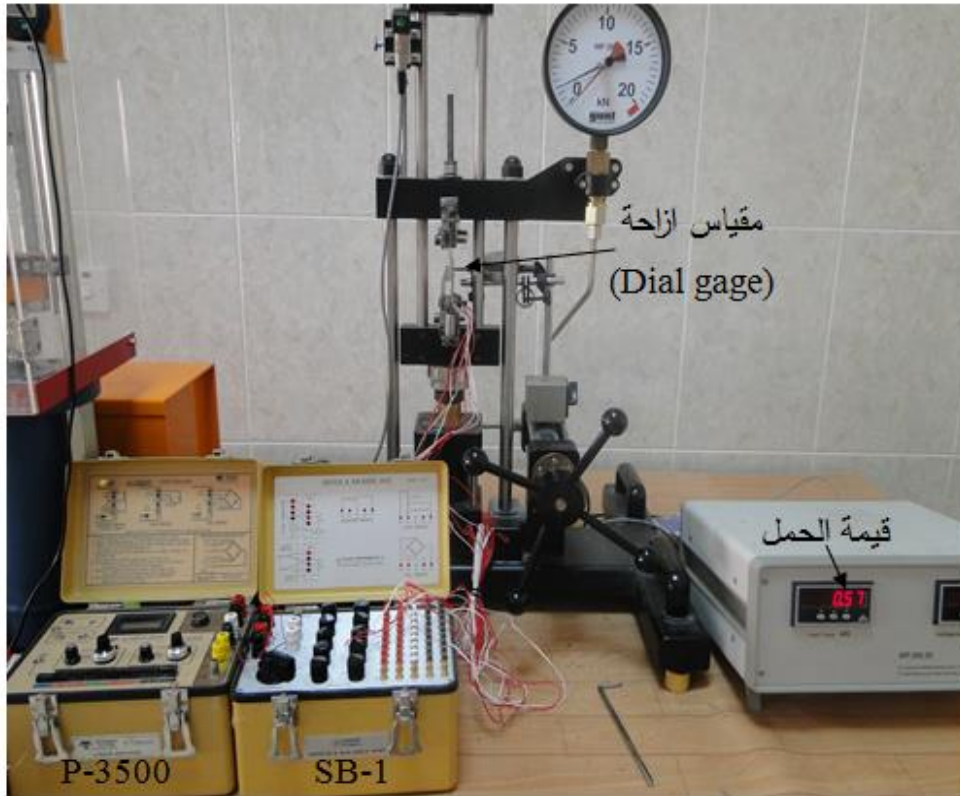
الشكل (3): جهاز مختبري لفحص الشد (WP 300 materials testing device) سعته (20 kN) استخدم في الجانب العملي لحالة الانبعاج.
